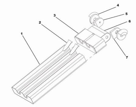
Figure 8.13 1) Arm Frame, 2) Gap Angles, 3) Cylinder Mount Block, 4) Bevel Gear, 5) Right Shaft Block, 6) Gap Blocker, & 7) Left Shaft Block
