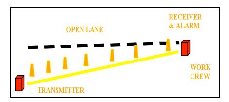
Figure 3. Basic Beam System<sup>[4]</sup>
