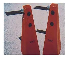
Figure 4. Beam Style Intrusion Alarm<sup>[3]</sup>
