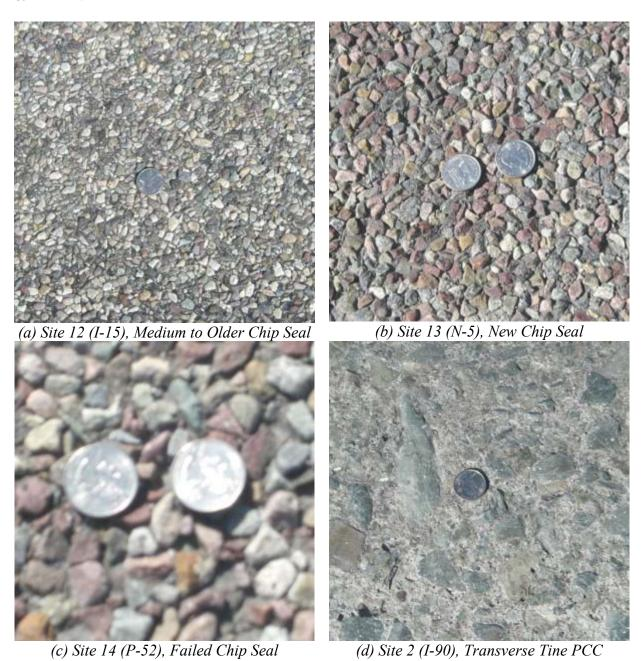
iled Chip Seal (d) Site 2 (I-90), Transverse Tine PCC Figure A1. Photos of Test Pavements
